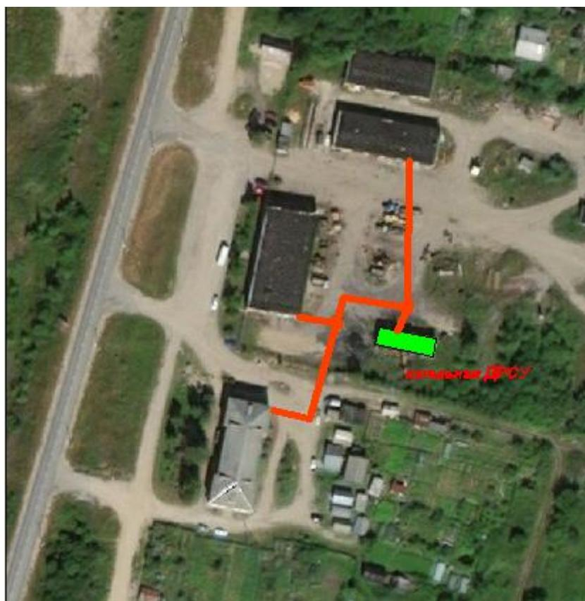
Рис. 1.10 – Зона теплоснабжения котельной ДРСУ
