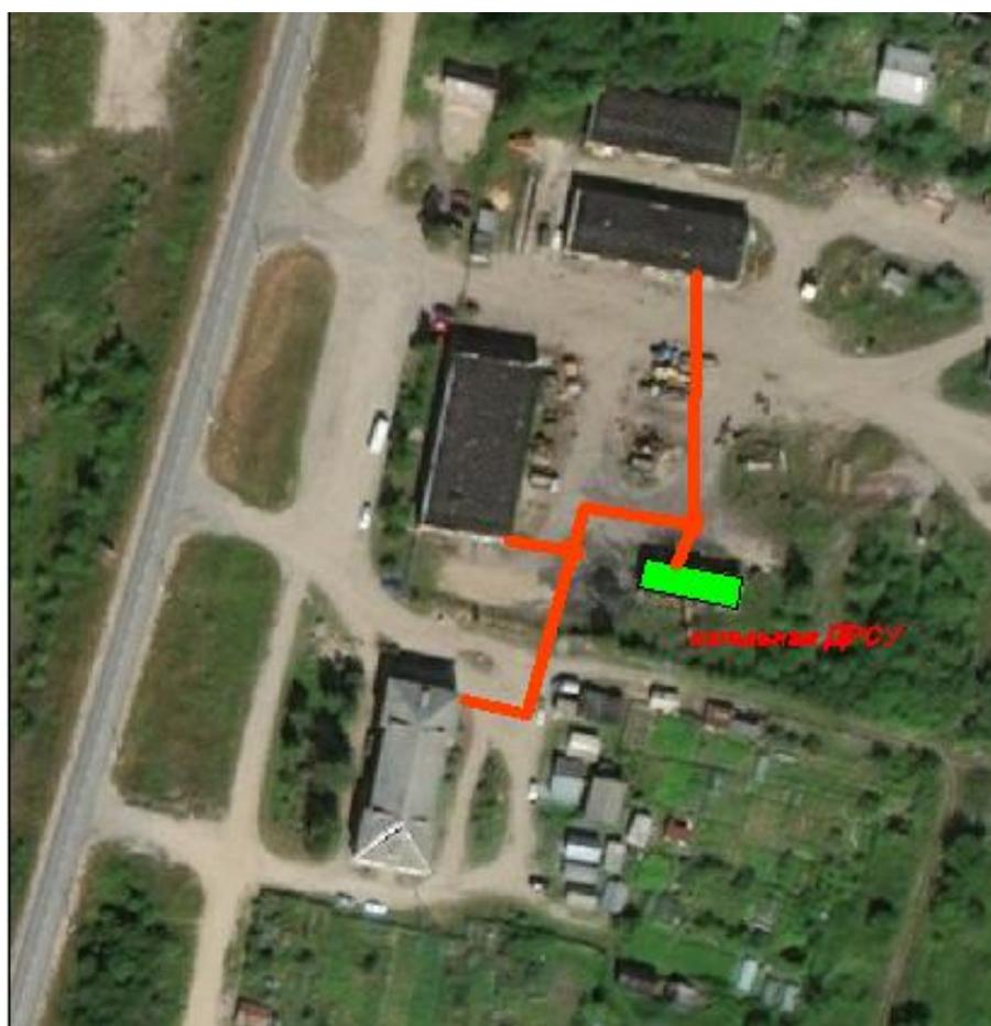
Рис. 1.10 – Зона теплоснабжения котельной ДРСУ
