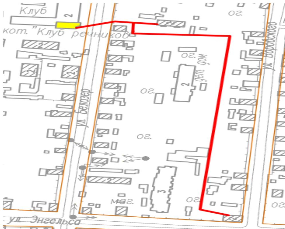
Рис. 1.6 – Зона теплоснабжения котельной «Клуб речников»
