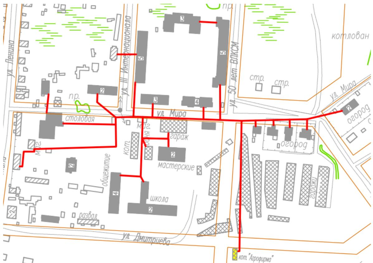
Рис. 1.2 – Зона теплоснабжения котельной «Агрофирма»
