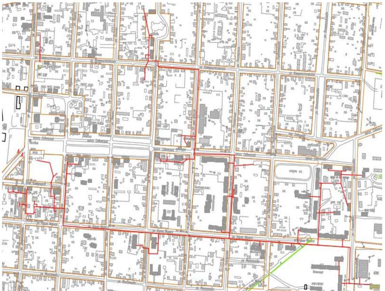
Рис. 1.1 – Зона теплоснабжения котельной «Оптика»
